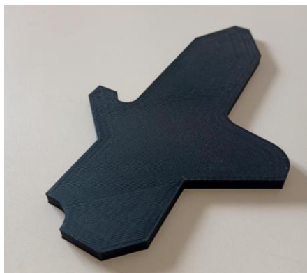
Foto 12: Gabarito para inspeção produzido após modelagem 3D
