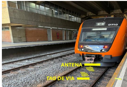
Figura 02: Ilustração do modelo de comunicação trem – via. Fonte: Autor, 2026.
