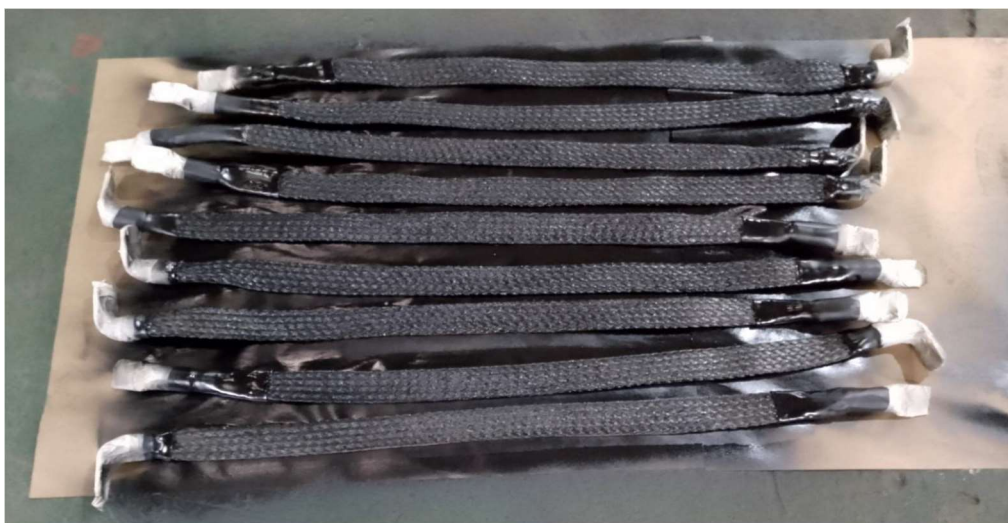
Figura 13 – cordoalha montada com terminais de conexão do bonde e trilho. Fonte: CPTM
