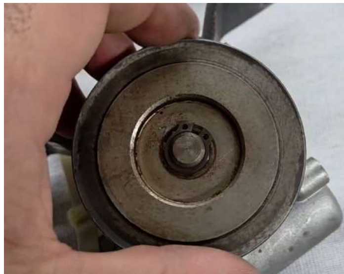
Figura 7 – Polia do motor, responsável pela interface entre o motor e a correia.
