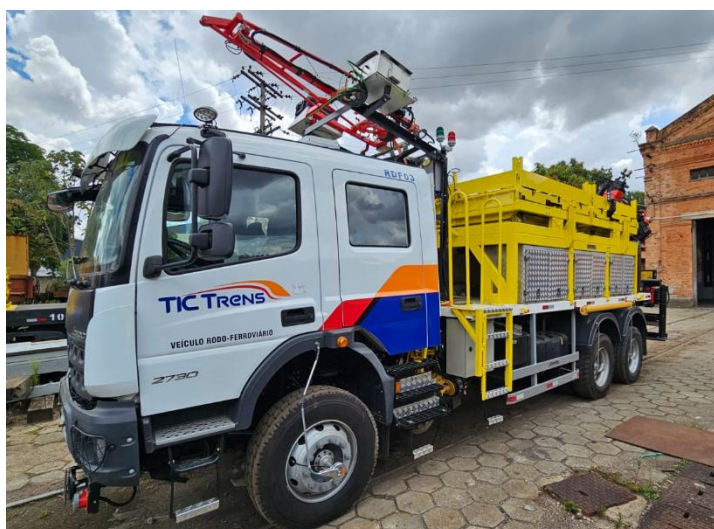
Figura 1 - Caminhão Multitarefas com Plataforma Aérea
