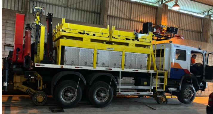
Figura 2 - Caminhão com o modo ferroviário acionado
