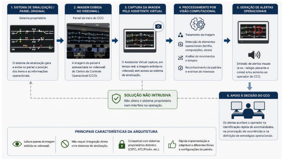
Figura 3 — Arquitetura funcional não intrusiva do Assistente Virtual do CCO: leitura da imagem do painel, processamento por visão computacional e geração de alertas para suporte à decisão operacional. Fonte: Elaborado pelos autores.
