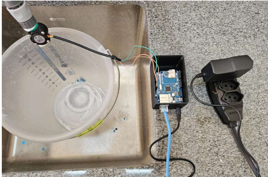
Figura 4 – Dispositivo medidor cabeado sendo testado em laboratório. Fonte: Arquivo Pessoal
