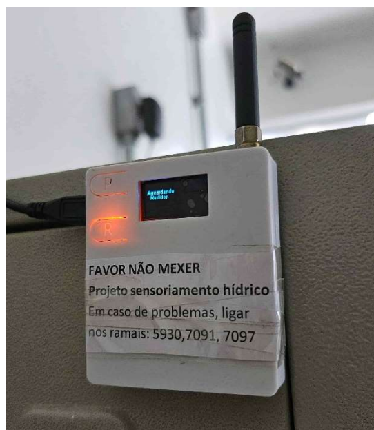
Figura 3 – Dispositivo repetidor instalado na estação piloto. Fonte: Arquivo Pessoal
