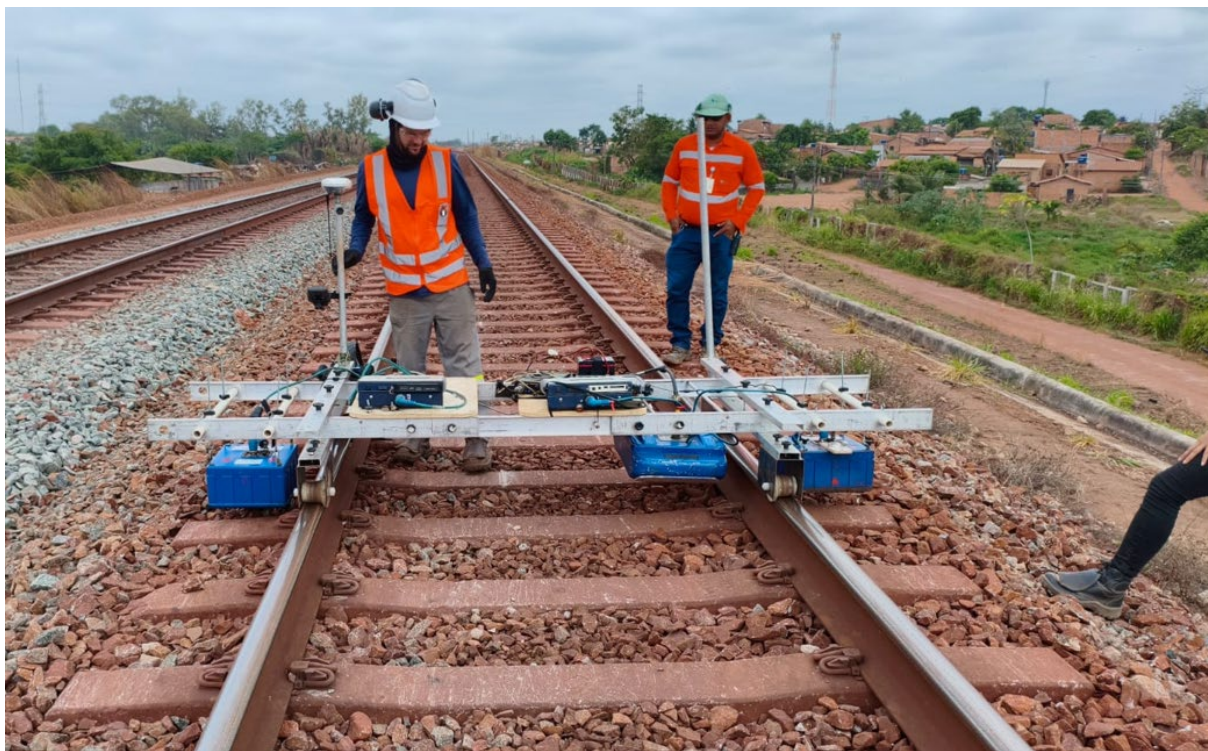
Figura 4 – Configurações de aquisição utilizadas nos levantamentos: (a) antenas de 400 MHz na lateral da via; e (b) sistema Detector Duo 250/700 MHz operado na parte central.
