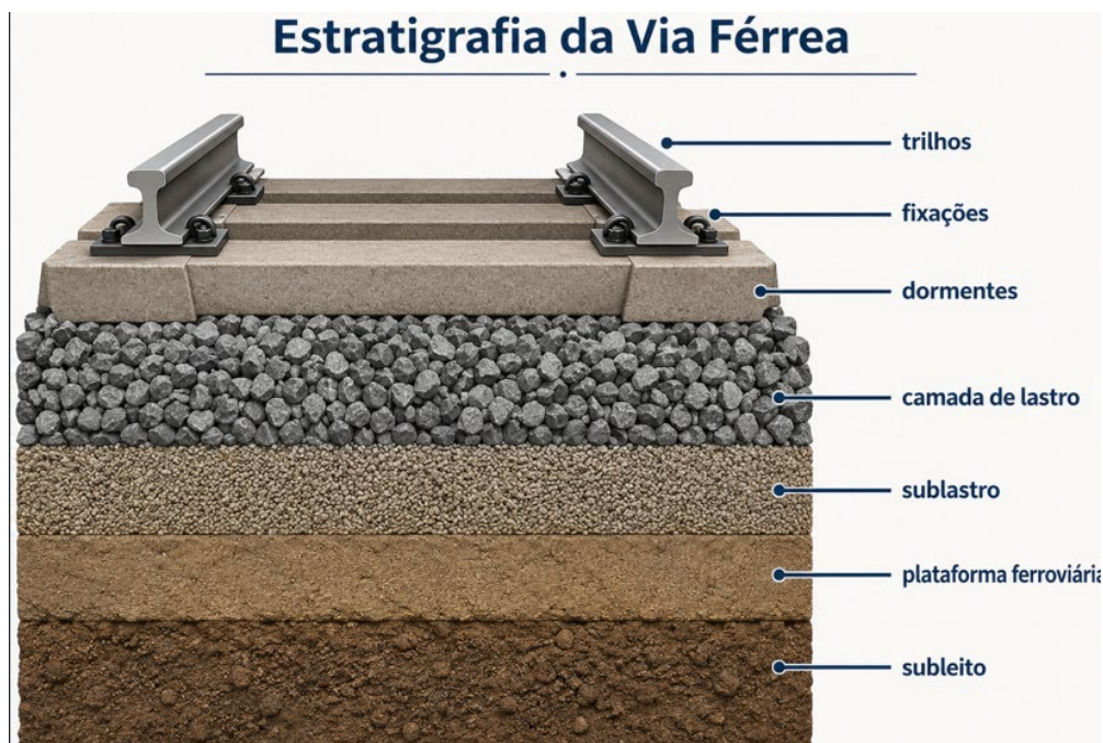
Figura 1 – Estratigrafia típica da via permanente e seus principais componentes.
