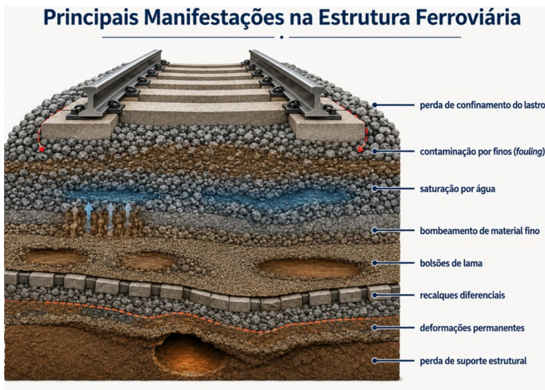
Figura 2 – Principais manifestações de degradação que podem ocorrer na estrutura ferroviária.
