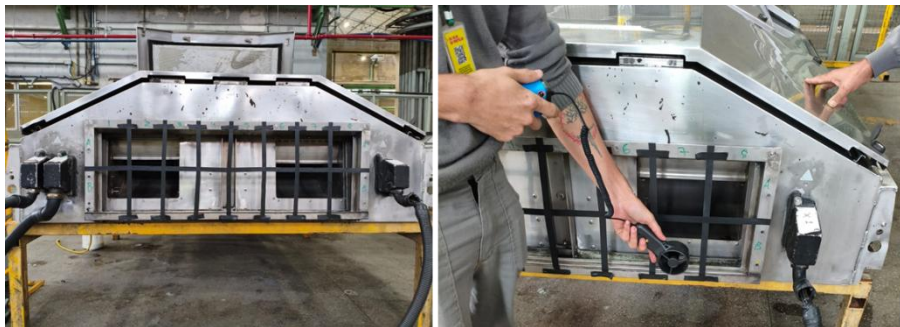
Figura 11 – Medições em campo da velocidade do ar insuflado. Fonte: Autor
