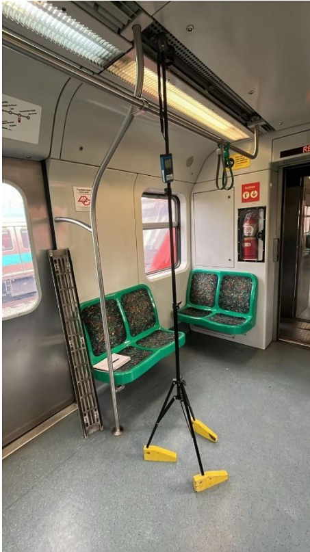
Figura 13 – Medição da velocidade do ar insuflado. Fonte: Autor
