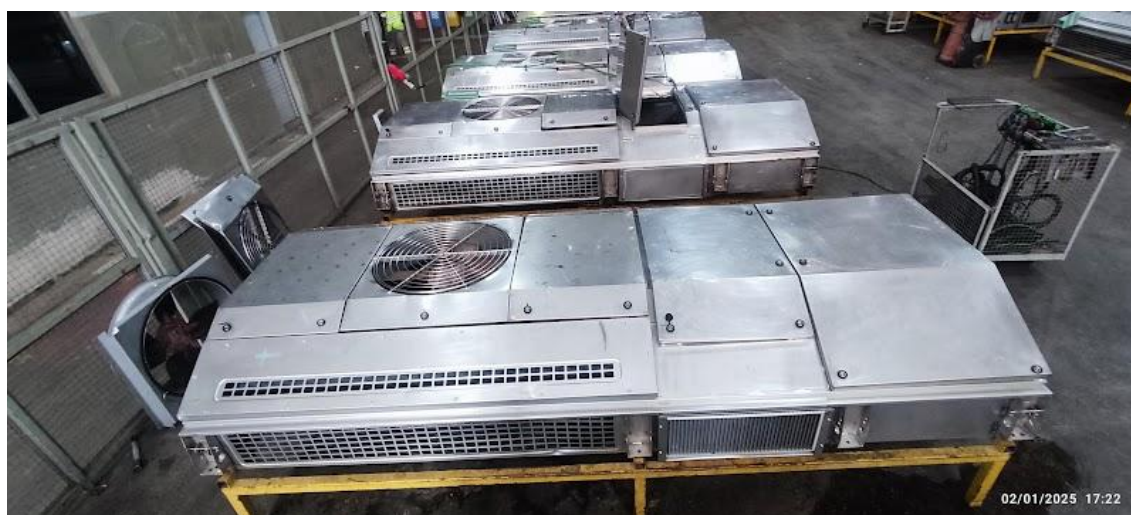
Figura 6 – Detalhe dos equipamentos de ar-condicionado Série 7000. Fonte: Autor.
