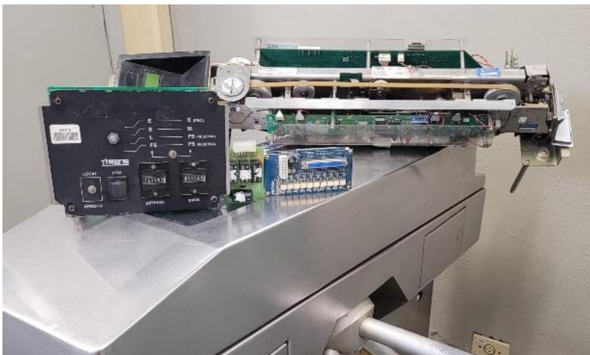
Figura 14- Partes interna substituídas pela eletrônica embarcada desenvolvida. Fonte: Acervo autor
