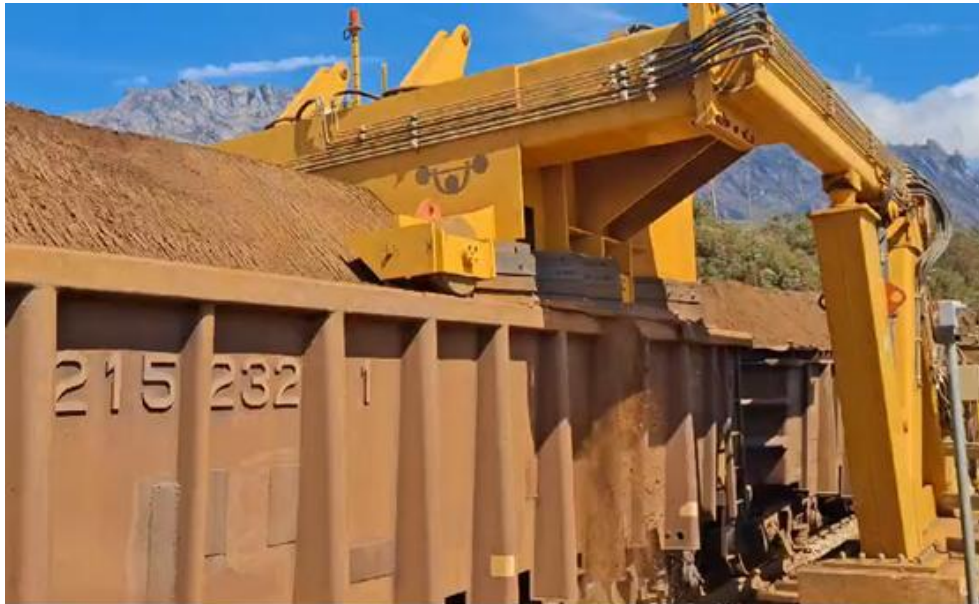
Figura 15 – Detalhe do Formatador em atividade. Fonte: Vale
