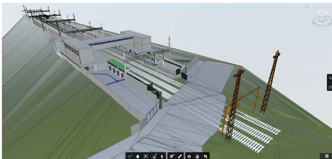
Figura 11-Modelo em Revit feito a partir de nuvem de pontos. Fonte: Autores.
