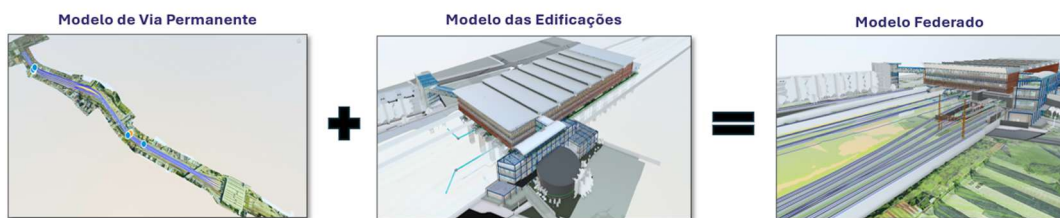
Figura 8 - Federação dos Modelos Estação e Via Permanente. Fonte: Autores.
