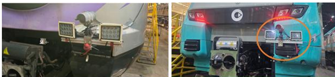
Figura 3 - Câmera com holofotes infravermelhos na frente do trem
