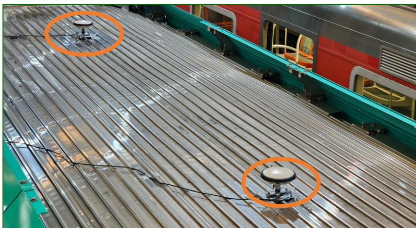
Figura 11 - Antenas GPS no teto do veículo. Fonte: Relatório de medição
