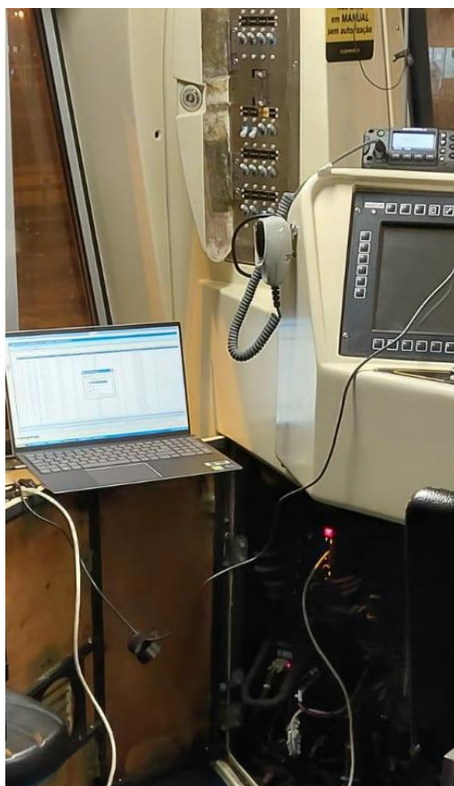
Figura 1 – Conexão do notebook de manutenção para extração dos registros de logs.
