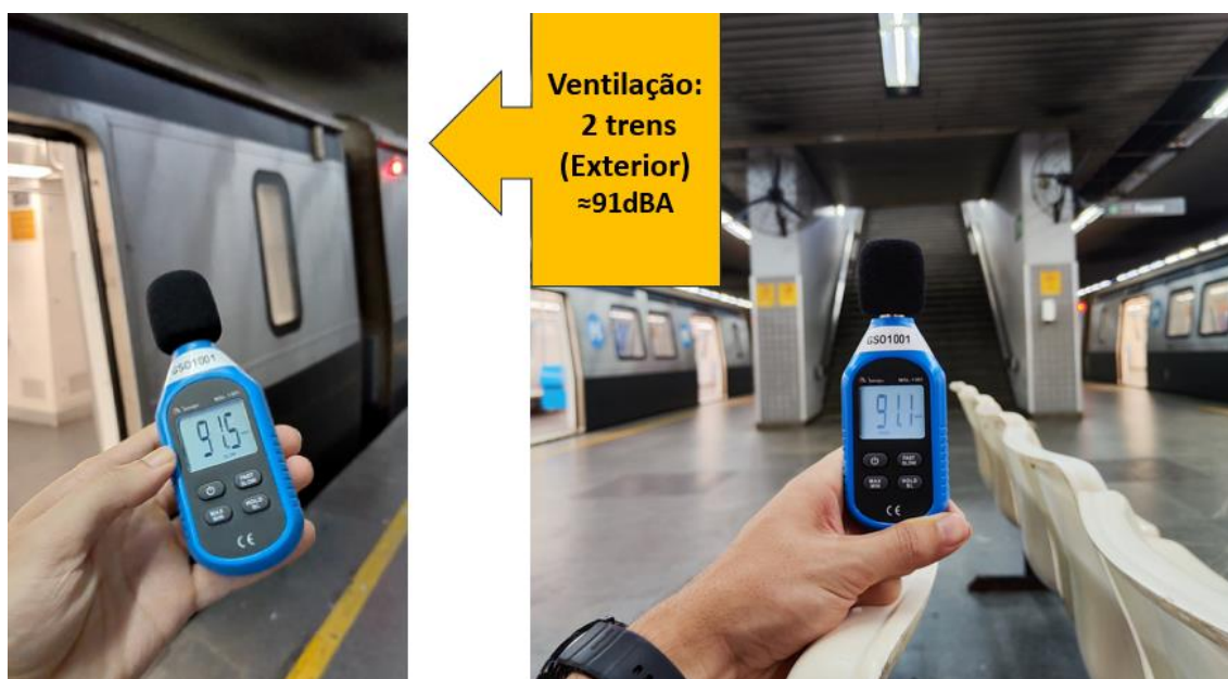
Figura 18 – Uso de decibelímetro na aferição de ruído na estação Estácio.
