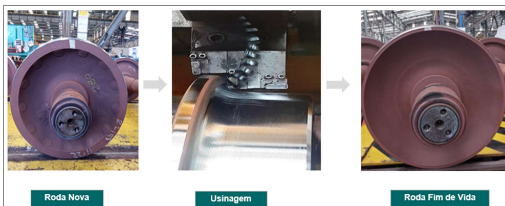
Figura 3. Demonstração de uma roda nova, reperfilamento até uma roda fim de vida.
