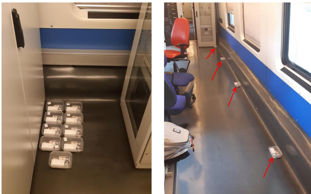
Figura 4. Instalação dos sensores no piso do trem Diamante para o primeiro dia (à esquerda) e para o segundo dia (à direita).
