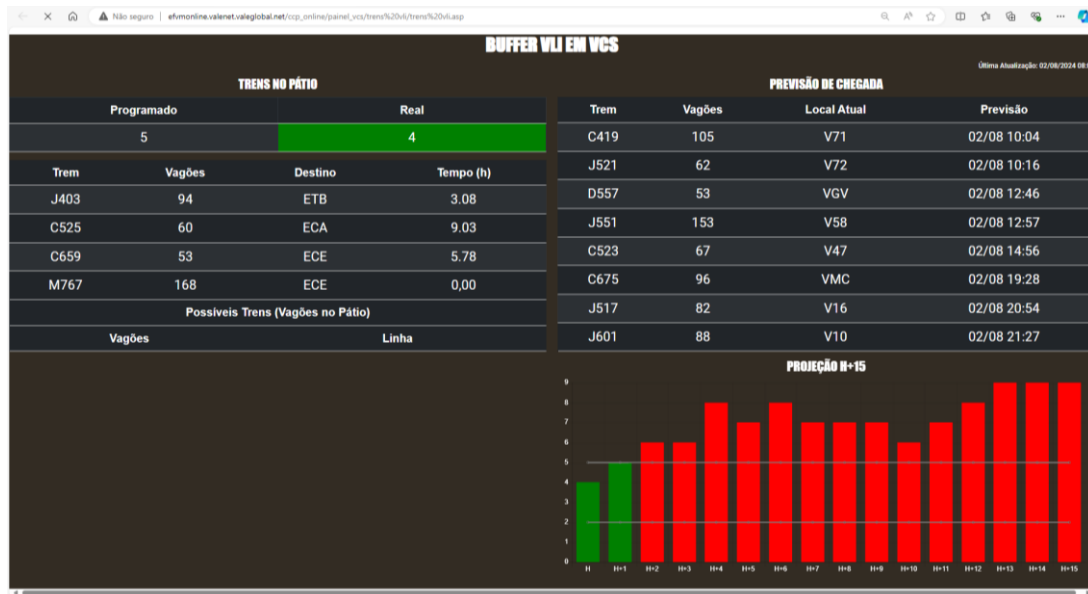
Figura 12: Alarme de ocupação de linhas destinada a carga geral com projeção H+16
