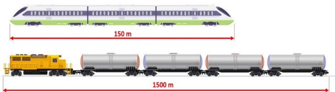
Figura 2 – Comparativo dimensional típico de trens de carga e de passageiros.
