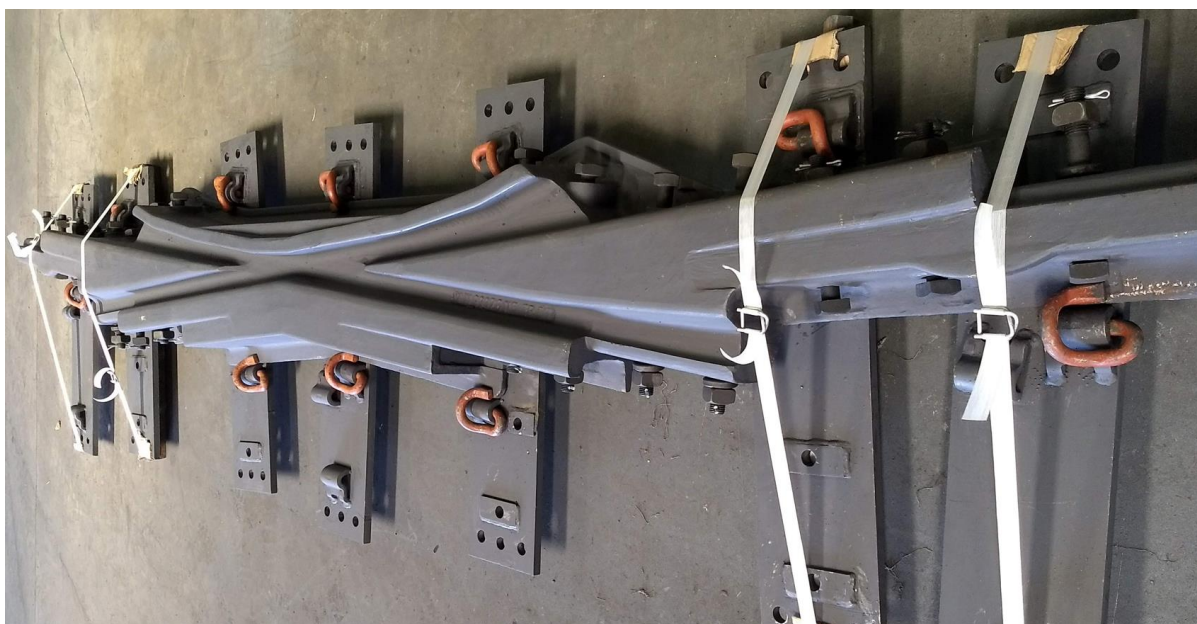
Figura 8 - Jacaré (cruzamento) especial N5, sendo inspecionado em fábrica
