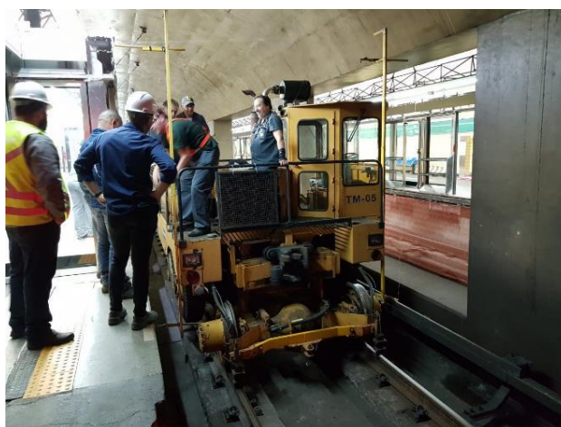
Figura 37 - Veículo de via gabaritado para validação de posicionamento da PSD
