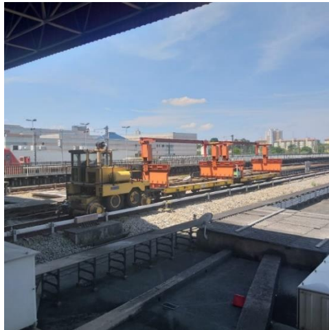
Figura 36 - Movimentação da vagoneta e convivência com a operação comercial na estação Corinthians Itaquera
