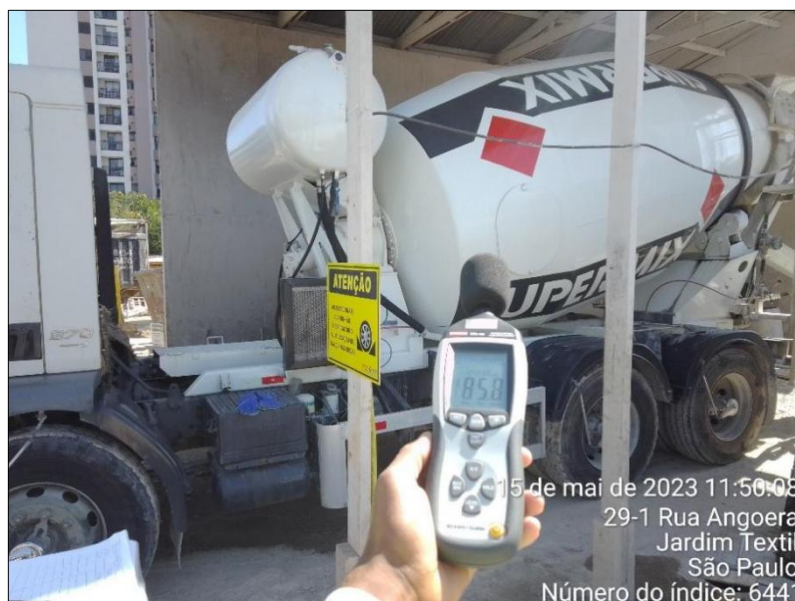
Foto 2 – Enclausuramento da betoneira para mitigação de ruído, solução realizada pela engenharia civil – Solução 1, sem o portão.
