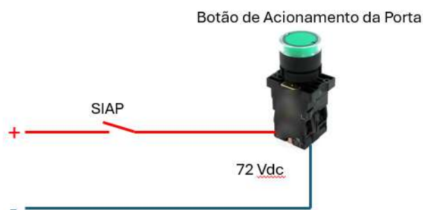
Figura 13 – Esboço do esquema elétrico do SIAP na botoeira da porta.
