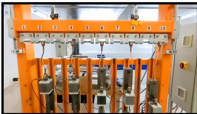
Figura 18 - Teste de fadiga realizado nos suspensórios, conforme norma EN50119
