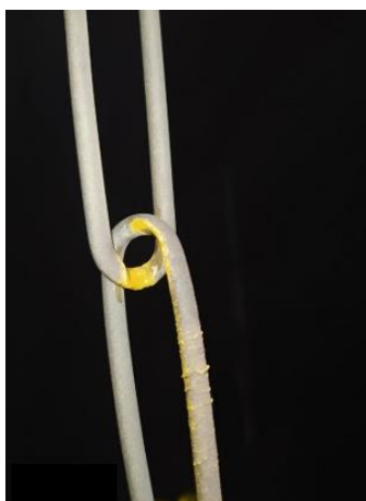
Figura 16 - Desgaste no suplemento do suspensório modelo antigo
