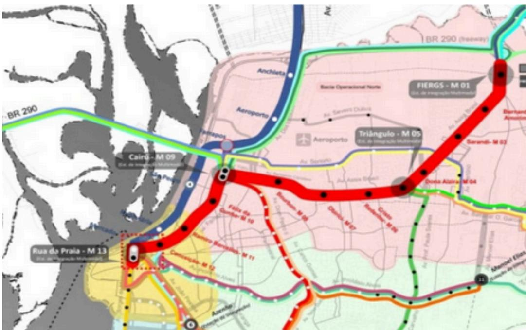
**Figura 3** – em vermelho a linha estruturadora denominada Metrô de Porto Alegre ou MetroPoA. em azul a linha 1 Trensurb, demais linhas troncais propostas com sistemas BRT (Bus Rapid Transit), BST (Bus Semi-rapid Transit) ou VLP (Veículo Leve sob Pneus).
