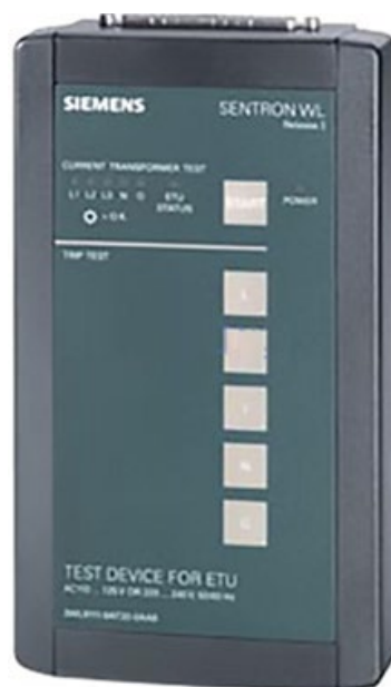
Figura 40 – Vista frontal do testador simplificado da ETUs Siemens 3WL (equipamento checa apenas o funcionamento do circuito lógico da ETU)
