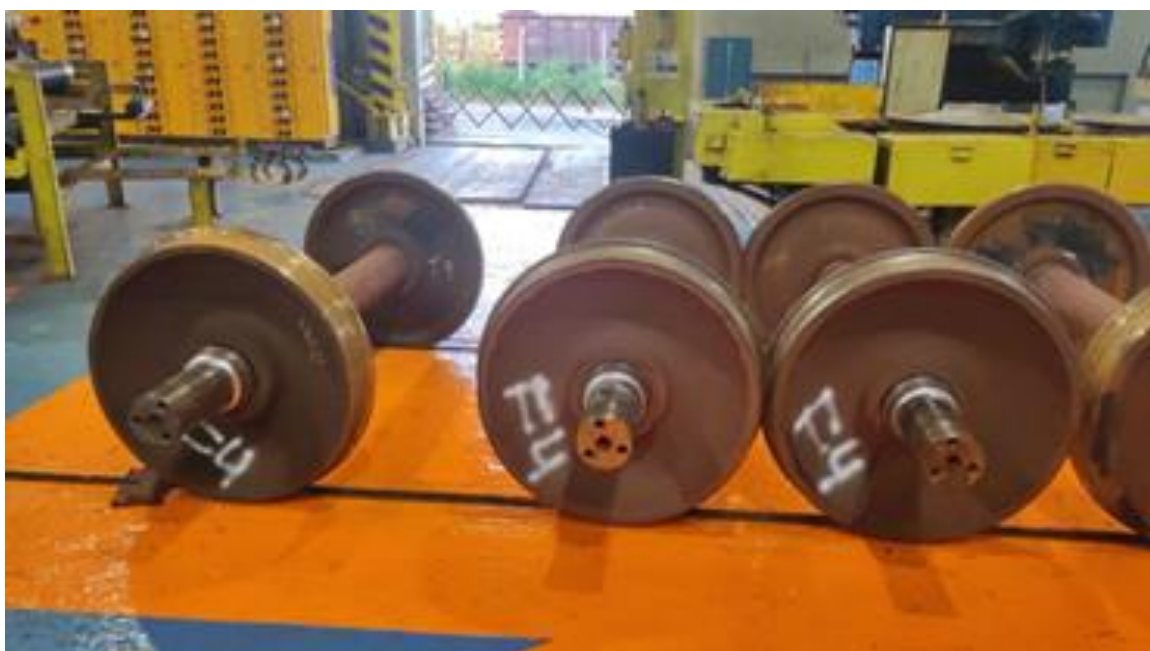
Figura 11. Rodas de amostra reutilizadas com tape \leq 200
