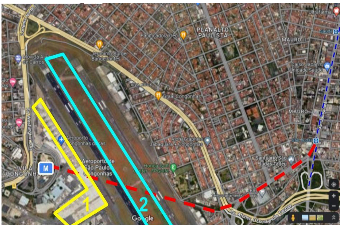
Fig 6. No terminal 1 de Congonhas, novo acesso externo ao Metrô L1-Azul, No terminal 2, novo hangar subterrâneo com acesso interno ao Metrô, Na Estação São Judas L1-Azul, acesso subterrâneo no nível da plataforma.[2]
