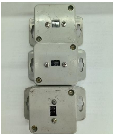
Figura 3 – Caixa do sensor TOF com a placa dividida e os 3 modelos: quadrado, horizontal e vertical
