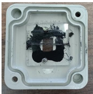
Figura 2 – Caixa do sensor TOF com a placa dividida
