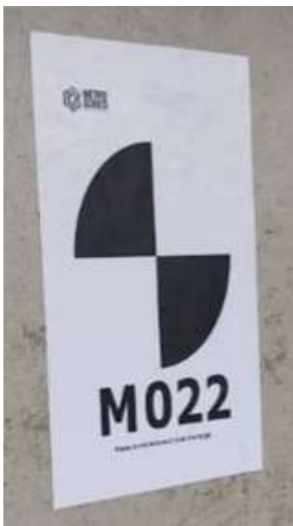
Figura 17- Target- Ponto de Controle (Foto acervo Metrô/CDT)
