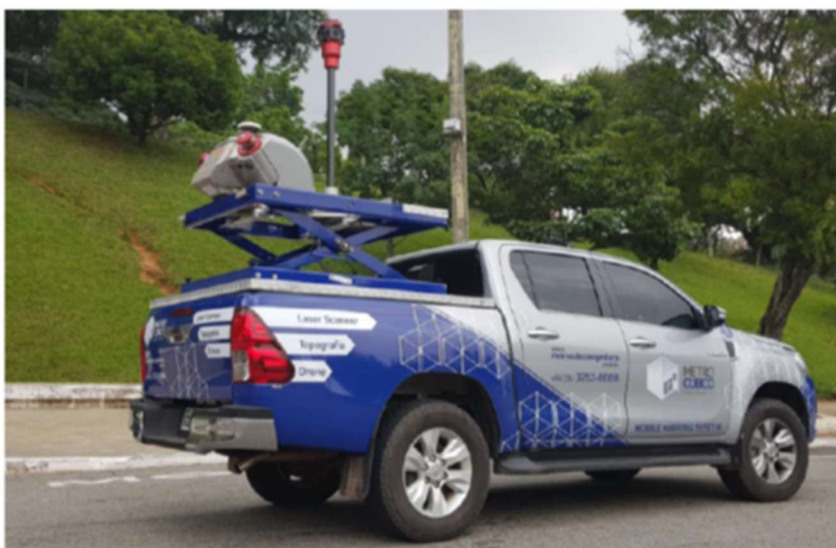
Figura 4 - Equipamento LiDAR MMS embarcado em veículo utilitário (Foto acervo Metrô/CDT)
