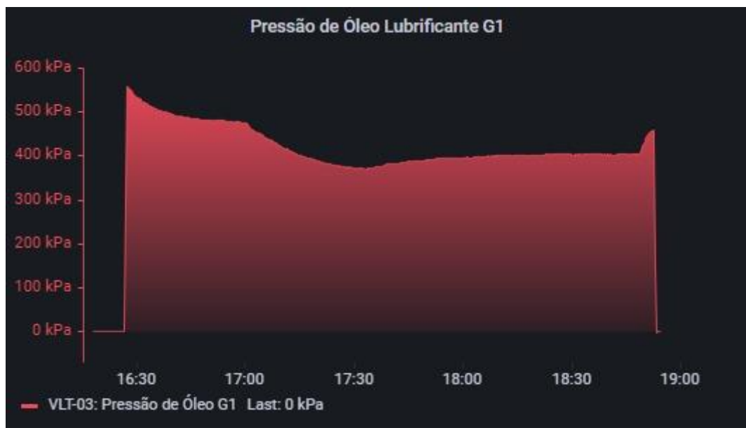
Figura 11 – Gráfico da pressão de óleo lubrificante do gerador em função do tempo.
