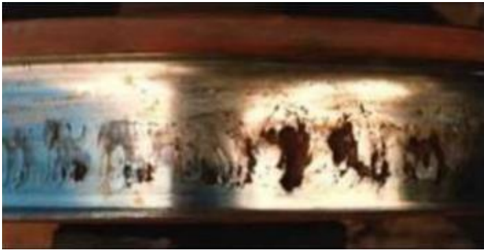
Figura 7. Roda com Descascamento
