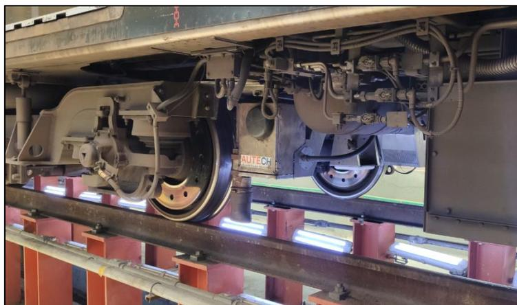
*Figura 1 – Equipamento instalado sob o 2º truque do 1º carro*
