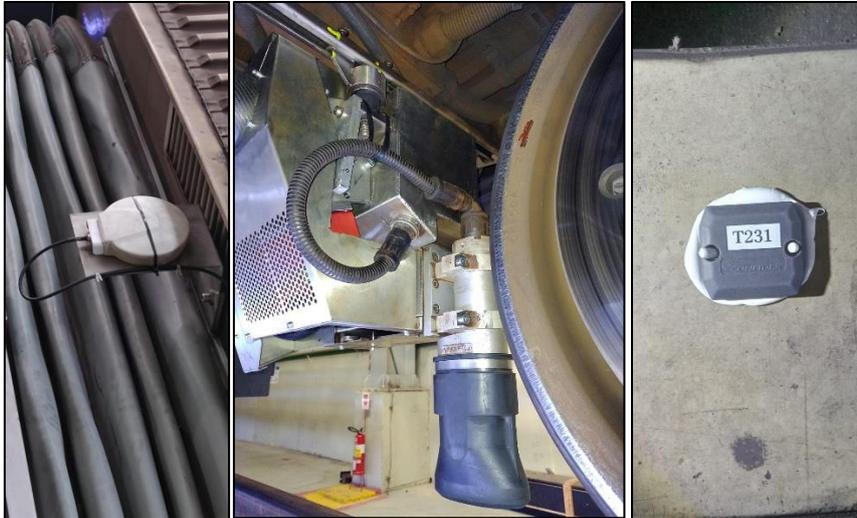
*Figura 4 - Antena GPS, Odômetro e TAG RFID*
