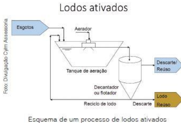
Figura 6 – Esquema ilustrativo do sistema de lodos ativados.
