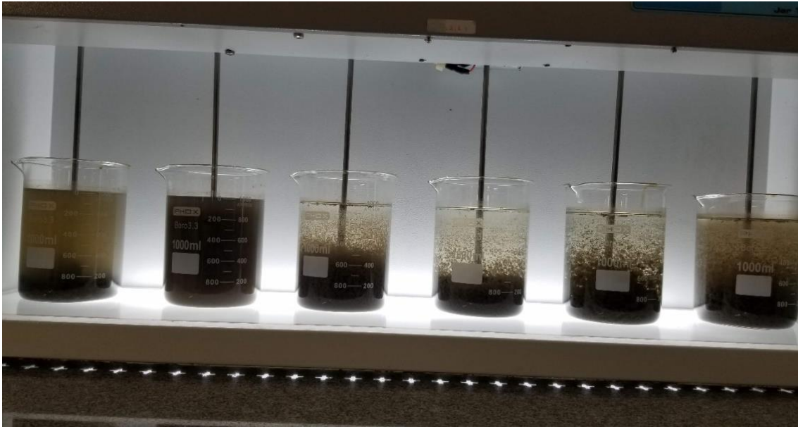
Figura 6 – Teste de bancada para avaliação de eficiência de flocculantes. Fonte: SENAI-RS.
